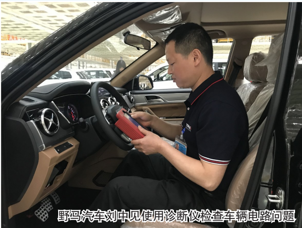
野马汽车刘中见使用诊断仪检查车辆电路问题
