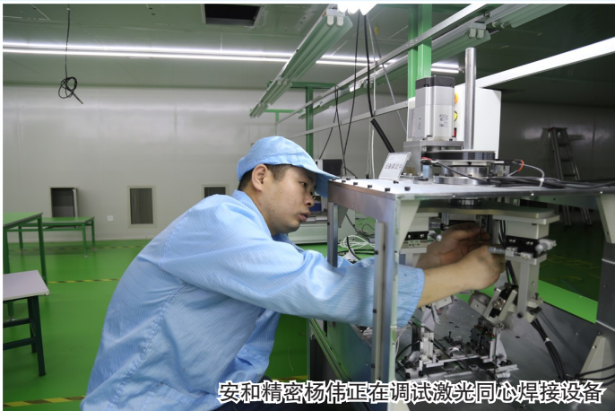
安和精密杨伟正在调试激光同心焊设备
