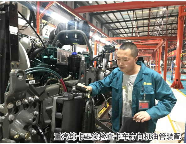
重汽绵卡里俊检查卡车方向机油管装配
