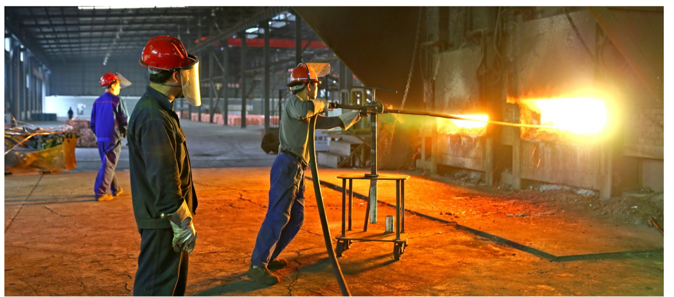
位于游仙区四川保和富山再生资源产业园“城市矿产”示范基地的绵阳铜鑫铜业有限公司,是国家资源综合利用重大示范工程建设项目,可年产再生铜材10万吨,产品广泛用于电线电缆、通信线缆行业,去年完成产值79.7亿元,累计增速达40%。目前,公司利用废杂铜为原料,通过新工艺新技术,已取得国家10项发明专利,其中“竖式氧化炉+节能式平板精炼炉+连铸连轧机联合生产工艺”属国内领先技术,已通过四川省科技成果鉴定。图为工人正冶炼回收的废铜。(本报记者 蒲滔 摄)
