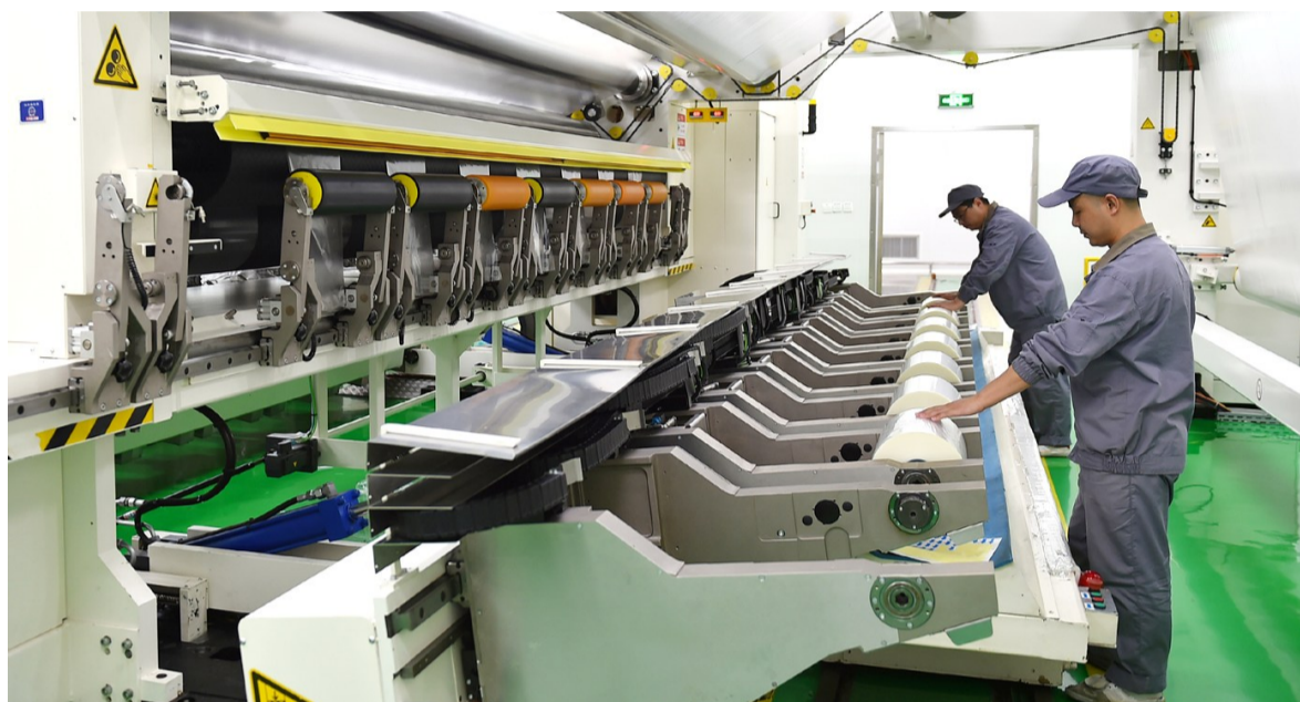
年产3500吨聚丙烯薄膜生产线上,工人正在对分切好的薄膜进行检查、卸卷。(本报记者 蒲涌 摄)
