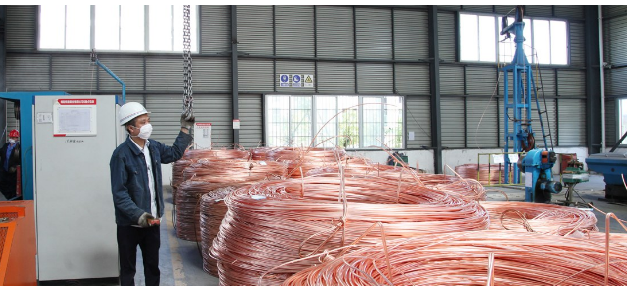
铜鑫铜业年产10万吨再生铜项目是国家城市矿产基地的首个再生资源加工项目,被列为市级重点建设项目之一。该项目总投资8亿元,全部达产后,预计产值超过100亿元,实现税收超过4亿元,提供就业岗位1000余个。其核心技术是以废旧铜作为原料,采用世界先进的拉拔特竖炉生产工艺、纯氧助燃及燃烧控制技术生产网络线缆及其他电缆产品,可比原生铜生产线缆产品节约能耗45%左右,年循环利用废铜12万吨。 (实习记者 任露霖 摄)
